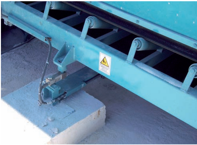
Detalle de la cinta colectora y células extensiométricas. Détail du convoyeur collecteur à bande et des cellules extensiométriques Detail of the collection belt and extensiometric cells.
